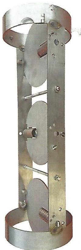
ausüben, sodass sich diese um die eigene Mittelachse drehen. Die Leitbleche weisen in Abhängigkeit der unterschiedlichen Abgastemperaturen variable Winkel auf. Die Beeinflussung steigt bei steigenden Abgastemperaturen und sinkt bei fallenden Temperaturen. Die Abgasströmungseinrichtung mit integriertem Wärmeübertrager ermöglicht eine Steigerung der Energieeffizienz.
