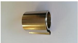
½ Zoll Messingtauchhülse mit Metallverschraubung PG7, ½ Zoll Dichtung mit ½ Zoll Gegenmutter zur Aufnahme des Sensors S1 an der Rauchrohrwand hinter dem TurbuFlex-Abgaswärmeübertrager
