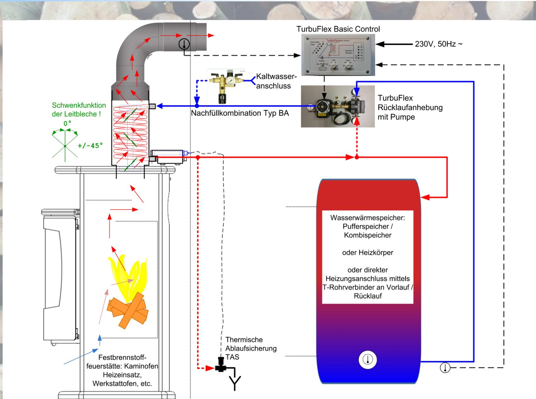
Für Feuerungsanlagen nach z.B. EN13240, EN13229, EN12815 mit DIBt-Zulassung für feste, gasförmige oder flüssige Brennstoffe, Ofenleistungsbereich 3 – 30 KW
